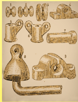
1885 Porcelain electrical insulators (La physique moderne : l'électricité dans la maison, É. Hospitalier)
